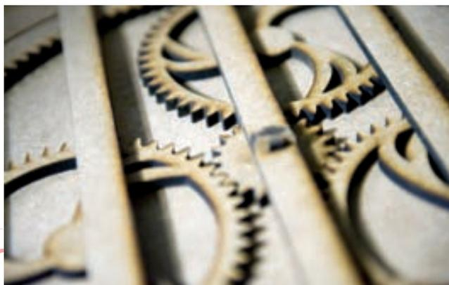
Mécanisme en bois conçu sur un logiciel de dessin vectoriel puis usiné avec la découpe laser.
